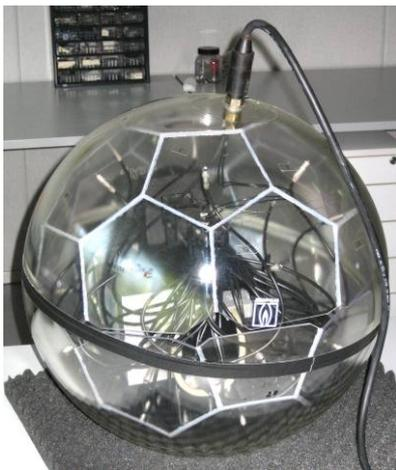
Figur 8: Lichtmesssonde gemäß DE 101 53 104 A1 in der technischen Umsetzung (copyright E.Sauter (AWI)).
